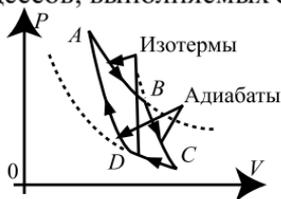
Круговой цикл, включающий в себя две изотермы и две адиабаты, соответствует максимальному КПД.
